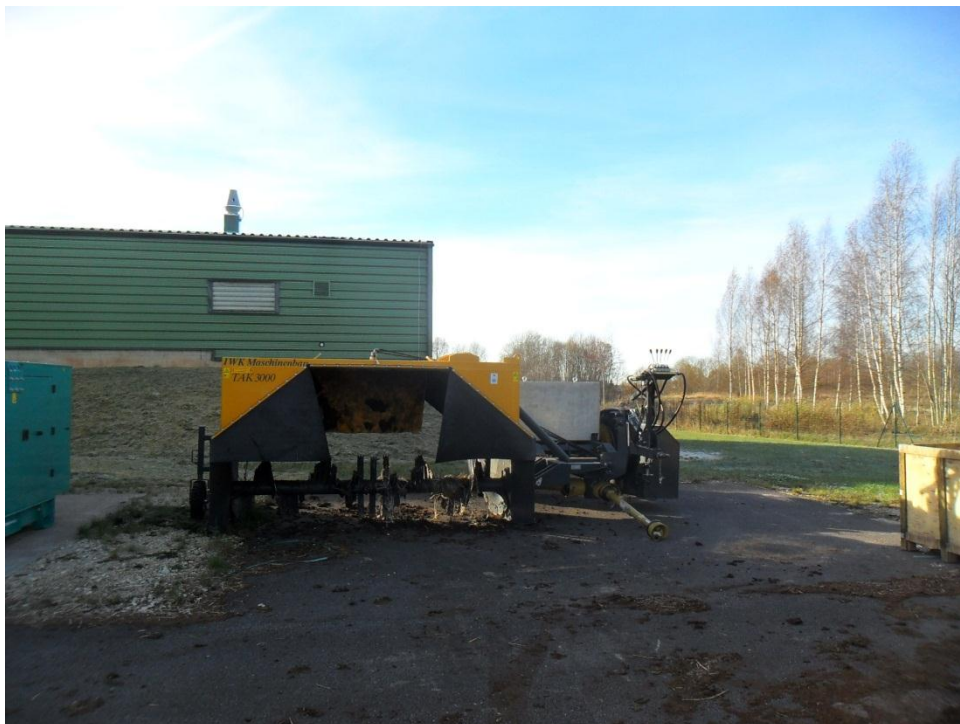
Joonis 5-14 Kompostainade segamiseks kasutatav iseliikuv aunasegaja
