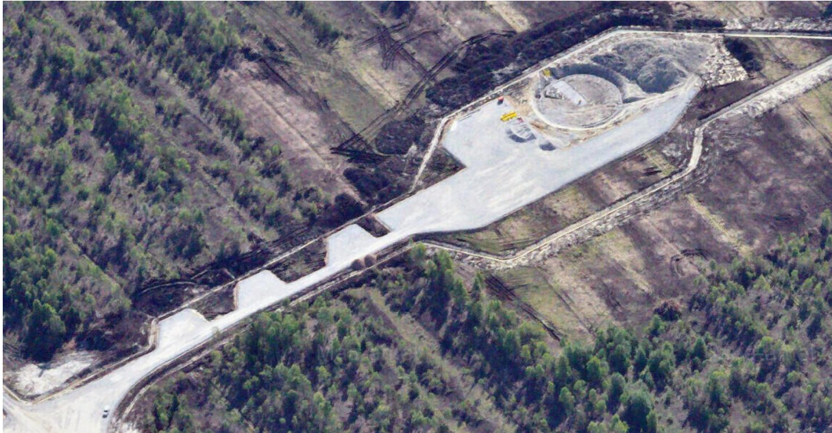
Joonis 4. Võimalik tuuliku vundamendi ala koos montaažiplatsidega. Allikas: Maa-amet kaldaerofoto – Tootsi/Sopi tuulepark. Montaažiplatsi täpne kuju ja pindala sõltub tuuliku tootja poolsest spetsifikatsioonist.
