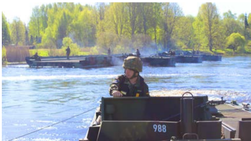
Selleks, et pontoonsild liikuma saada, peavad mitu meest seda niimoodi samal ajal juhtima.
